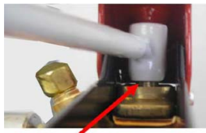
2. För in mätverktyget för att mäta ventilspindelns höjd
